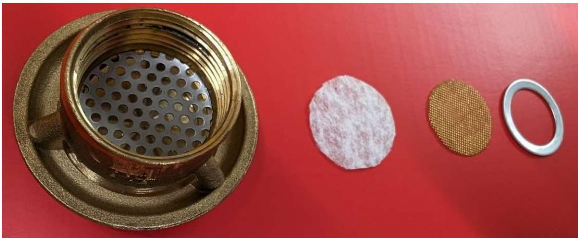
Das Flies ist auf beiden Seiten mit einem Stahl/Messingsieb gestützt.
