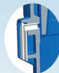
Verschluss der Entwässerung im Betriebszustand Closure of the drainage during operation
